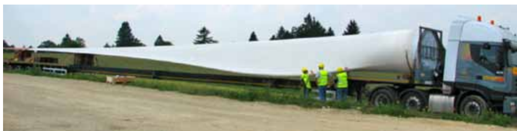
Ces nouvelles éoliennes ont une puissance de 2000 kW et une hauteur de mât de 95 m. La hauteur totale culmine à 140 m. Le poids total de l'éolienne, sans le socle, est de 300 t (ci-dessus, le transport d'une pale).
